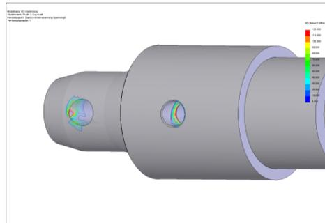
Ausbreitung der Anpress-Breite  $a_p$  beträgt ( Kontaktdruck FEM)
