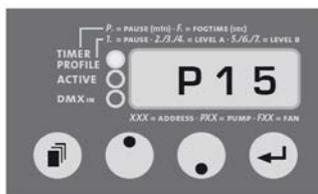
Abb. 17: Einstellen des Pumpen-Wertes
