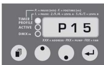
Abb. 5: Einstellen des Pumpen-Wertes
