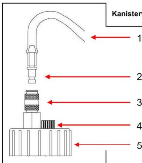
**Kanisterverschluss mit integriertem Sinterfilter**
